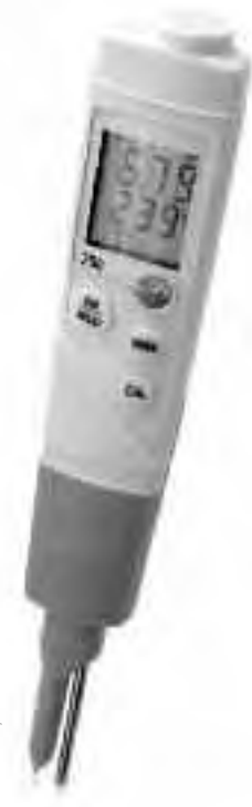
Sonda pH2 para alimentos semisólidos
