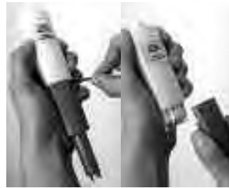
Cambio sencillo de sonda en los testo 205 y testo 206-pH1/-pH2/-pH3
